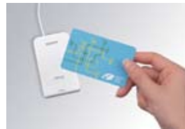
用植物塑料制作的搭载“FeliCa”技术的非接触型IC卡
